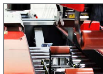
TESTA NASTRANTE INFERIORE BOTTOM TAPING HEAD
