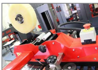
TESTA NASTRANTE SUPERIORE TOP TAPING HEAD
