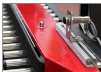
FOTOCELLULA LETTURA SCATOLA FOTOCELLS THAT DETECT BOX
