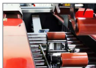
TESTA NASTRANTE INFERIORE BOTTOM TAPING HEAD
