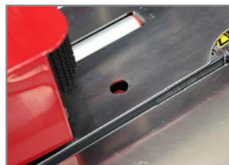
SENSORE PER REGGIATURA AUTOMATICA AUTOMATIC STRAPPING SENSOR
