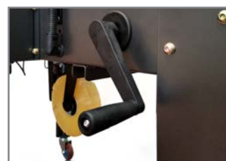
REGOLAZIONE LARGHEZZA SCATOLA BOX WIDTH ADJUSTMENT
