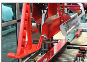
DISPOSITIVO PNEUMATICO CHIUDIFALDE PNEUMATIC FLAP CLOSURE DEVICE
