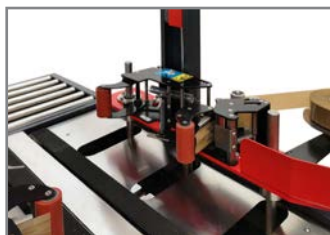
CINGHIE DI TRASCINAMENTO INFERIORI BOTTOM BELTS FEEDING
