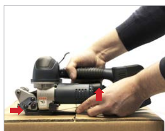
Inserimento della reggetta Insert strap
