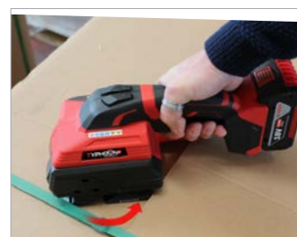
Sgancio automatico della reggetta Automatic strap release
