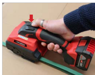
Tensionamento tramite pulsante Tensioning by button
