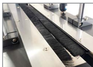
DETTAGLIO PRESSINO PNEUMATICO PNEUMATIC TOP PRESS
