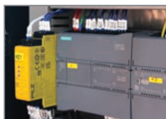
MACCHINA GESTITA DA PLC SIEMENS MACHINE CONTROLLED BY PLC SIEMENS
